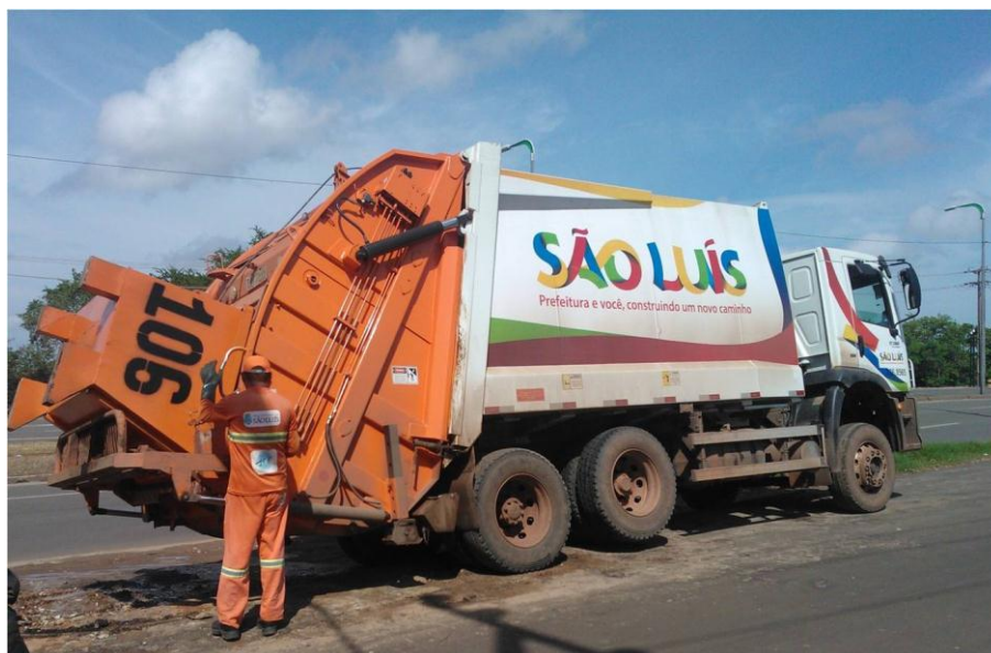
Figura 3: Compactação dos resíduos coletados
