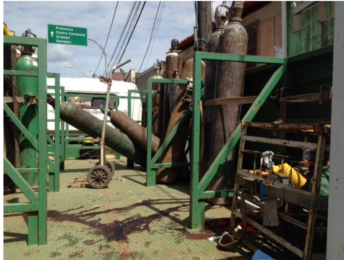
Figura 4: Cilindros de acetileno sem amarração, com risco de queda e explosão.
