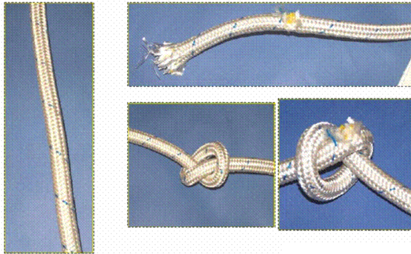
Figura 34: Corda perfeita e com danificações
