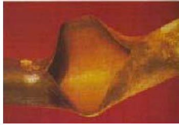
Figura 3 – Superaquecimento por curto período
