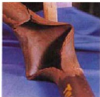
Figura 2 – Ruptura por deformação plástica
