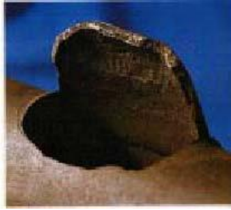
Figura 5 – Ruptura induzida por hidrogênio
