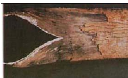
Figura 1 - Ruptura por Oxidação Térmica
