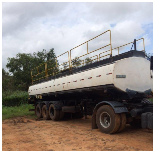
Figura 16 – Vista lateral do sistema Guarda-corpo – rodapé após a fabricação do projeto. Fonte: Autora
