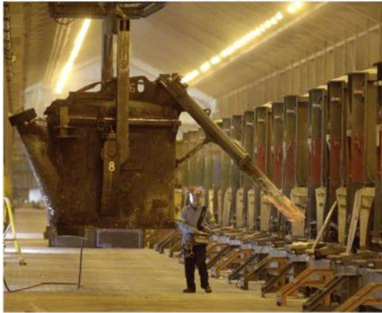
Ilustração 13: Exemplo de Transporte de Cadinho com ponte Villares
