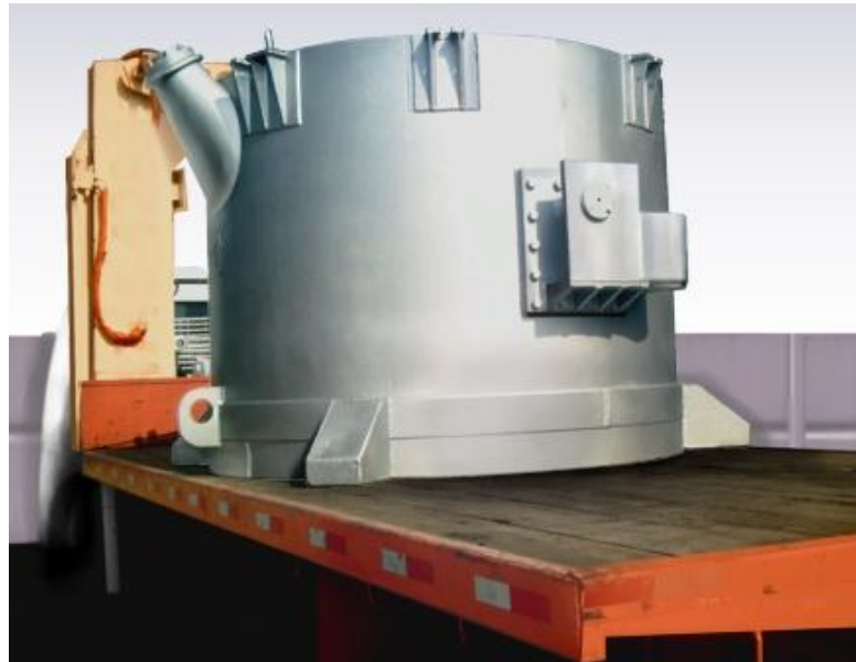
Ilustração 12: Modelo de Cadinho para transporte de alumínio líquido
