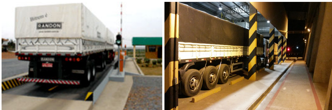
Figuras 09 e 10 - Balança de pesagem e plataforma de coleta, amostragem e classificação de grãos
