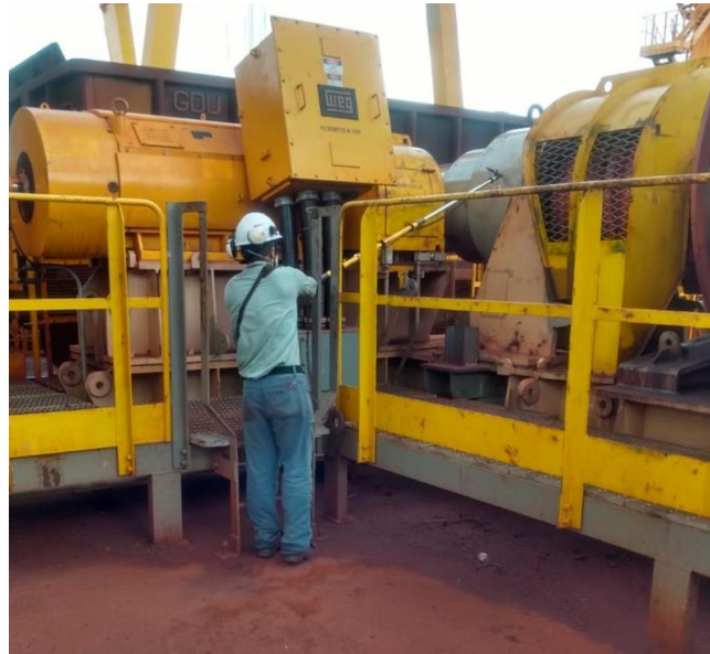
Figura 02: Inspetor da preditiva coletando vibração com bastão de coleta, sem retirar proteção de máquina.
