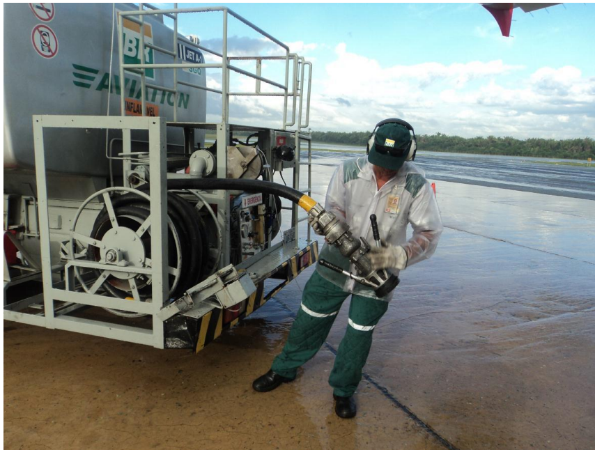
Figura 19: Operador de abastecimento retirando a mangueira do carretel
