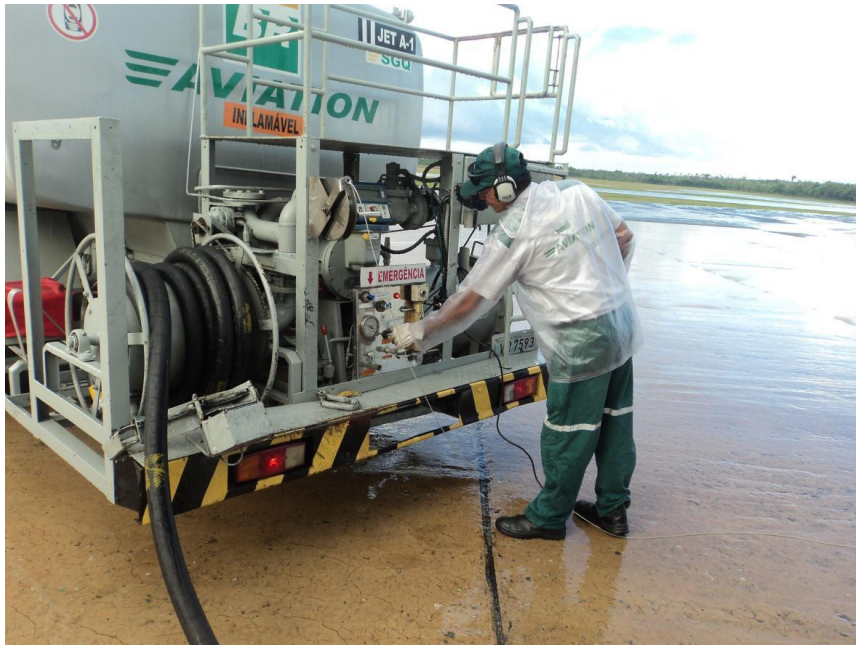
Figura 20: Conexão do cabo terra do CTA na aeronave
