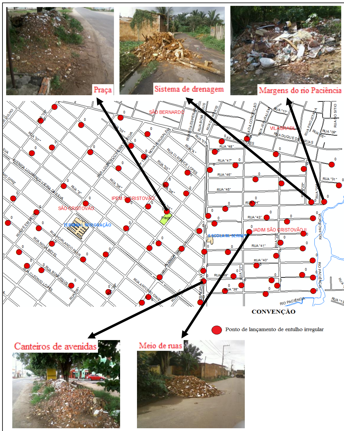
Figura 7 – Mapa com os pontos de lançamentos de entulho irregulares - Arc Gis Version 9.3 Fontes: Elaborado pelo Autor 2013
