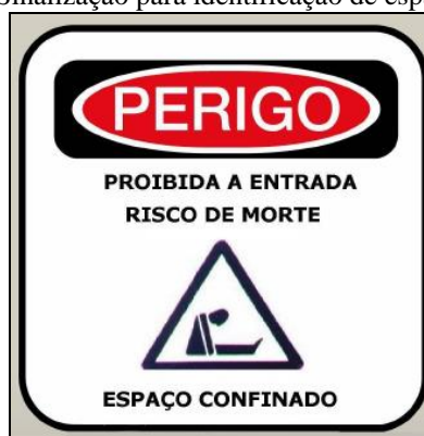
Figura 10 – Sinalização para identificação de espaço confinado
