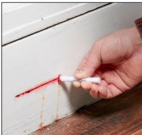
Figura 5 - Aplicação do Swabs Lead Check
